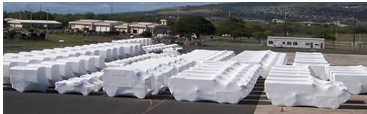
Intercept folie beschermt voertuigen tegen corrosie
